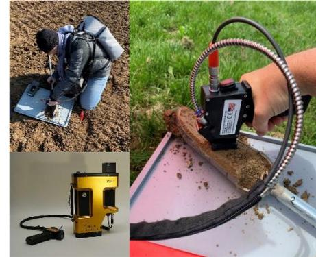
**PSR+3500** Spectromètre vis-NIR
