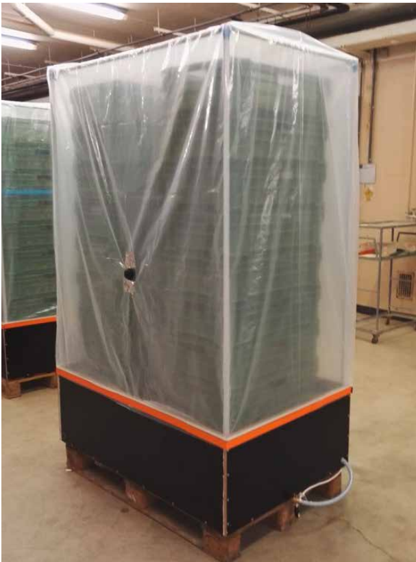
Abb. 1 | Von Agroscope hergestellte automatisierte Versuchseinheit, die voneinander unabhängige Behandlungen der Kartoffeln in derselben Kühlkammer ermöglicht. (Foto: Margot Visse-Mansiaux, Agroscope)
